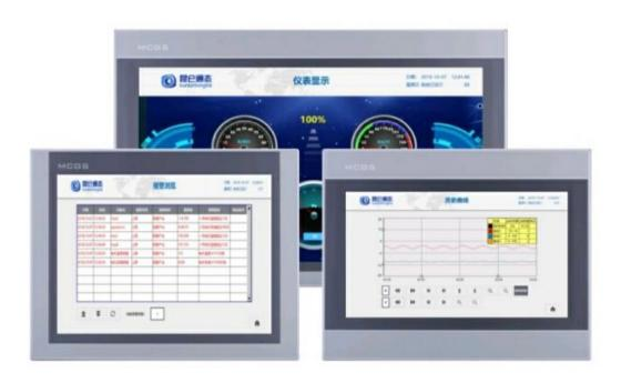
本系统通过 MCGS 人机界面对接现场 PLC 控制系统。MCGS 是北京昆仑通态自动化软件科技有限公司研发的一套基于嵌入式平台打造的一块现场实时监控、控制的上位机,主要完成现场数据的采集与监测、前端数据的处理与控制。
